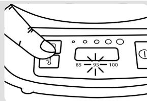
Sélectionnez la température souhaitée à l'aide du bouton de sélection de la température **9**. Appuyez sur le bouton à plusieurs reprises pour passer d'une option à l'autre.
