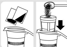
Fyld tekurven med løs te, og anbring den i tragten **7**.
