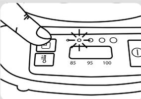
Включите Заварочный чайник в сеть электропитания. С помощью кнопки Крепость **8** установите желаемую крепость чая. Перемещение от одной опции к другой производится последовательным нажатием кнопки.
