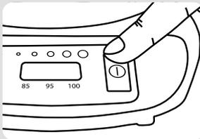
Başlat tuşuna **10** basın, suyun sıcaklığı Dijital Ekran **11** üzerinde görünecektir. Su doğru sıcaklığa ulaştığında, ekran üzerinde bir zamanlayıcı görünür ve çayınızın kaynaması sona erene kadar geri sayım yapar.
