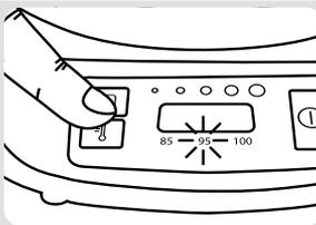
Επιλέξτε τη θερμοκρασία που επιθυμείτε με το κουμπί θερμοκρασίας **9**. Πατήστε το κουμπί επαναληπτικά για να μεταβείτε κυκλικά στις διάφορες επιλογές.
