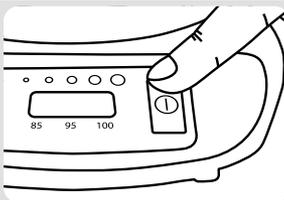
Naciśnij przycisk startu **10** – temperatura wody pojawi się na wyświetlaczu cyfrowym **11**. Gdy woda osiągnie odpowiednią temperaturę, na wyświetlaczu pojawi się minutnik, który będzie odliczał czas aż do zakończenia zaparzania herbaty.
