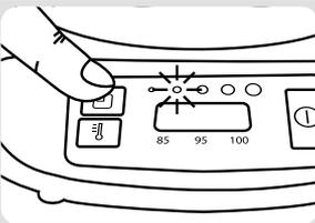
Sätt i kontakten. Med styrkereglaget **8** kan man välja önskad styrka på teet. Tryck på knappen upprepade gånger för att få fram rätt styrka.
