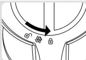
Placez le réceptacle dans la verseuse en veillant à mettre le couvercle fi dans la bonne position et à bien le verrouiller. Posez la verseuse sur le socle **2**.
