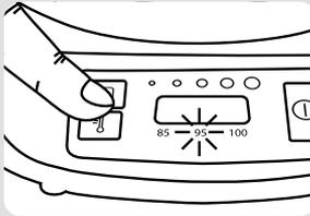
Sıcaklık Tuşunu **9** kullanarak istenen sıcaklığı seçin. Seçenekler arasında dolaşmak için tuşa ardi ardına basın.
