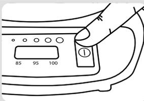
Tryck på startknappen **13**. Vattentemperaturen visas på digitaldisplayen **11**. När vattentemperaturen har uppnåtts visas en timer på skärmen som räknar ner tills ditt te har bryggs färdigt.
