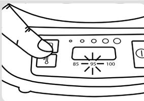
Pomocí tlačítka teploty nastavte požadovanou teplotu **9**. Opakovaným stisknutím tlačítka se pohybujete mezi jednotlivými možnostmi.
